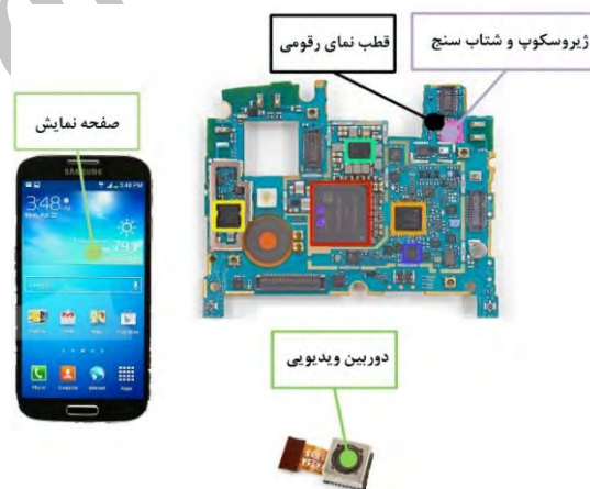
شکل ۵ - یک تلفن همراه هوشمند و حسگرهای به کار رفته در آن
