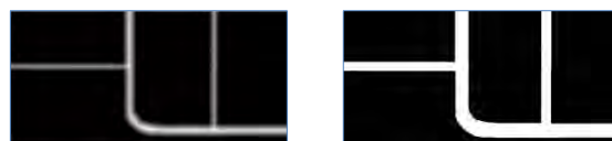
الف) تصویر ورودی (ب) تصویر تابع فاصله شکل ۲- تابع فاصله یک تصویر باینری
