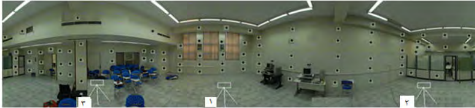
شکل ۱- تصویر پنورامای اتاق آزمون و محل قرارگیری لیزر اسکندر در سه ایستگاه
