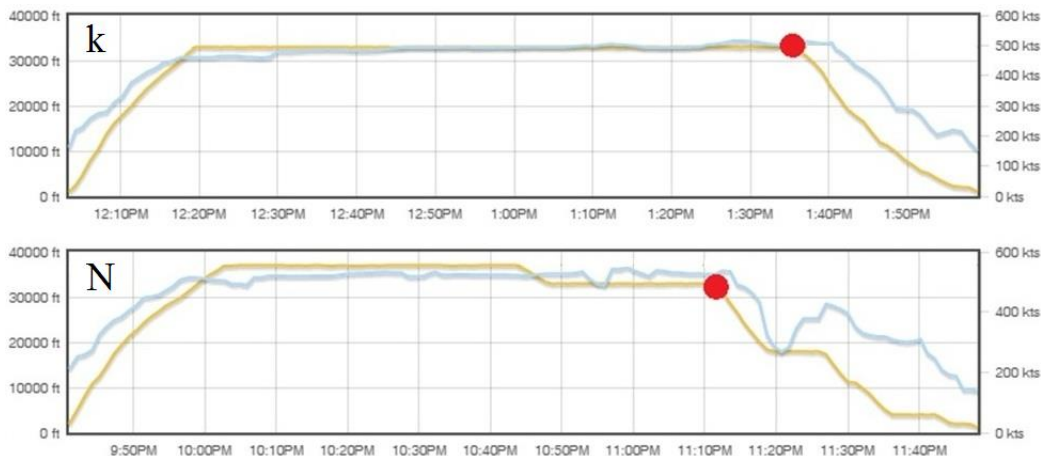
شکل ۸- دو خطسیر K و N با تقریب‌های متفاوت (خط زرد رنگ ارتفاع، خط آبی رنگ سرعت و نقطه قرمز رنگ آغاز عملیات تقرب)
