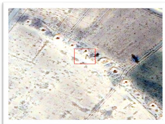
شکل ۴- ادغام عکس فتوگرامتری و تصویر ماهواره‌ای به روش اهلر (بالا) و بزرگنمایی شده آن (پایین)
