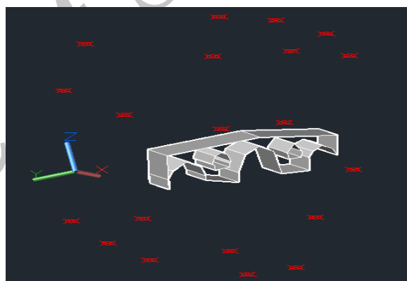
شکل ۲- مدل سه بعدی پل سید محمد واقع در زنجان در محیط اتوکد، نقاط قرمز موقعیت‌های بدست آمده برای چهارپره در الگوریتم IND
