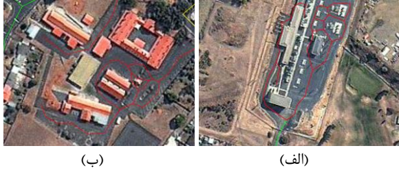
شکل ۸- ضعف روش پیشنهادی در حذف پارکینگها و کریدورهای محدوده‌های صنعتی و مناطق مشابه (FP با رنگ سرخ نمایش داده شده)
