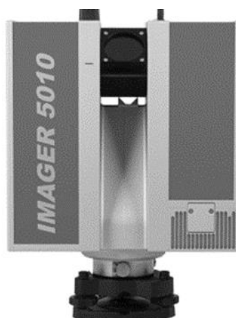
شکل ۱- لیزر اسکنر زمینی ۵۰۱۰Z+F IMAGER®
