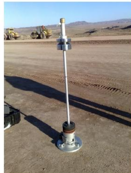
شکل ۲. استقرار دستگاه افت و خیزسنج ضربه‌ای سبک در مسیر خاکریز راه آهن قم- اصفهان
