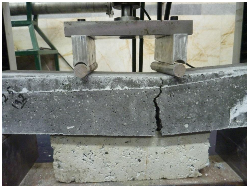
شکل ۸. یکی از نمونه‌های خمشی شکسته شده در آزمایش خمش سه نقطه‌ای
