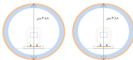
شکل ۲. مقطع عرضی تونل‌های دوقلوی خط ۱
