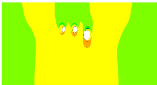
شکل ۱۶. تغییر شکل‌های قائم ایجاد شده در حالتی که تونل تکی با فاصله افقی معادل ۱/۵ برابر قطر و افزایش عمق معادل ۰/۵ برابر قطر نسبت به تونل‌های دوقلو حفاری شده است.
