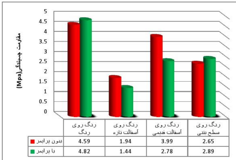
شکل ۱۸. تأثیر پرایمر بر مقاومت چسبندگی در سطوح مختلف
