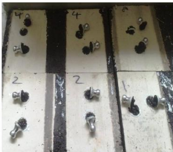
شکل ۶. جداسدگی گیره آزمون از بافت آسفالت در بررسی اندرکنش رنگ و آسفالت
