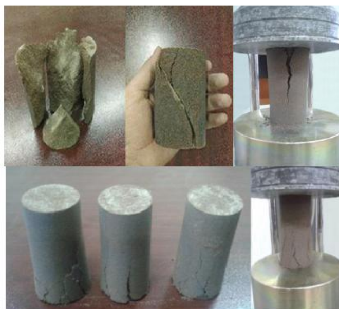
شکل ۸ الف) نمونه‌های تست شده دارای الیاف (تصاویر پایینی) و ب) نمونه‌های تست شده فاقد الیاف (تصاویر بالایی)
