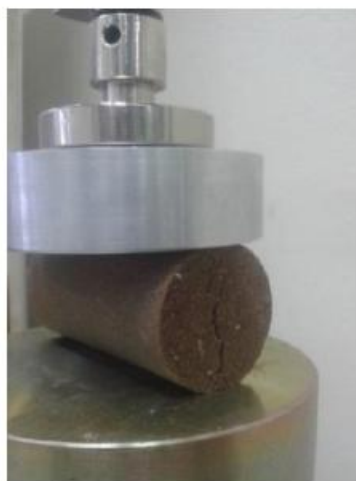
شکل ۵. نحوه قرارگیری نمونه جهت انجام آزمایش کشش
