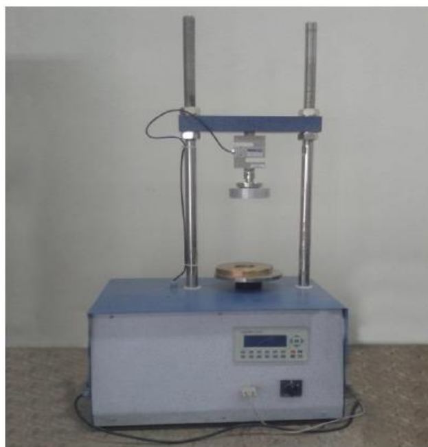
شکل ۴. تصویر دستگاه آزمایش فشاری تک‌محوری
