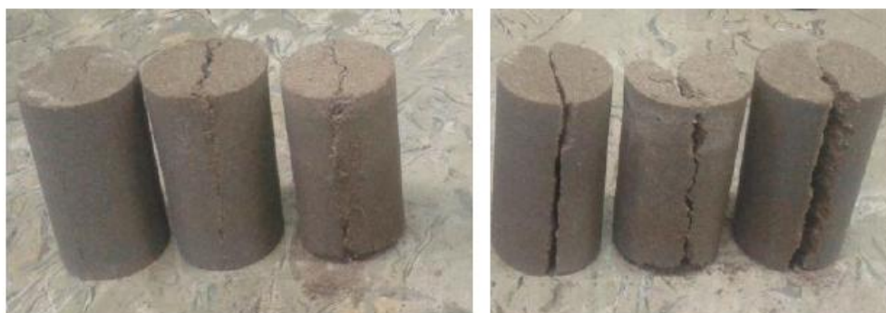
شکل ۱۱. الف) نمونه‌های تست شده دارای الیاف (تصویر سمت چپ) و ب) نمونه‌های تست شده فاقد الیاف (تصویر سمت راست)
