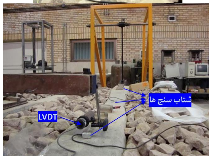
شکل ۳: نصب سه شتاب‌سنج و LVDT جهت آزمایش
