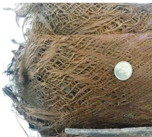
شکل ۱. بافت پارچه‌گونه الیاف نخل
