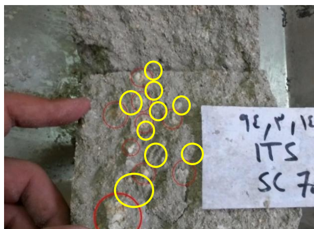
شکل ۴. صفحه شکست نمونه تثبیت شده بدون الیاف
