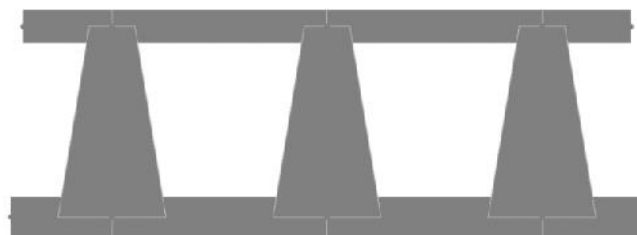
شکل ۴. مدل‌سازی یک پایه تیپ از پل مینا در SAP2000
