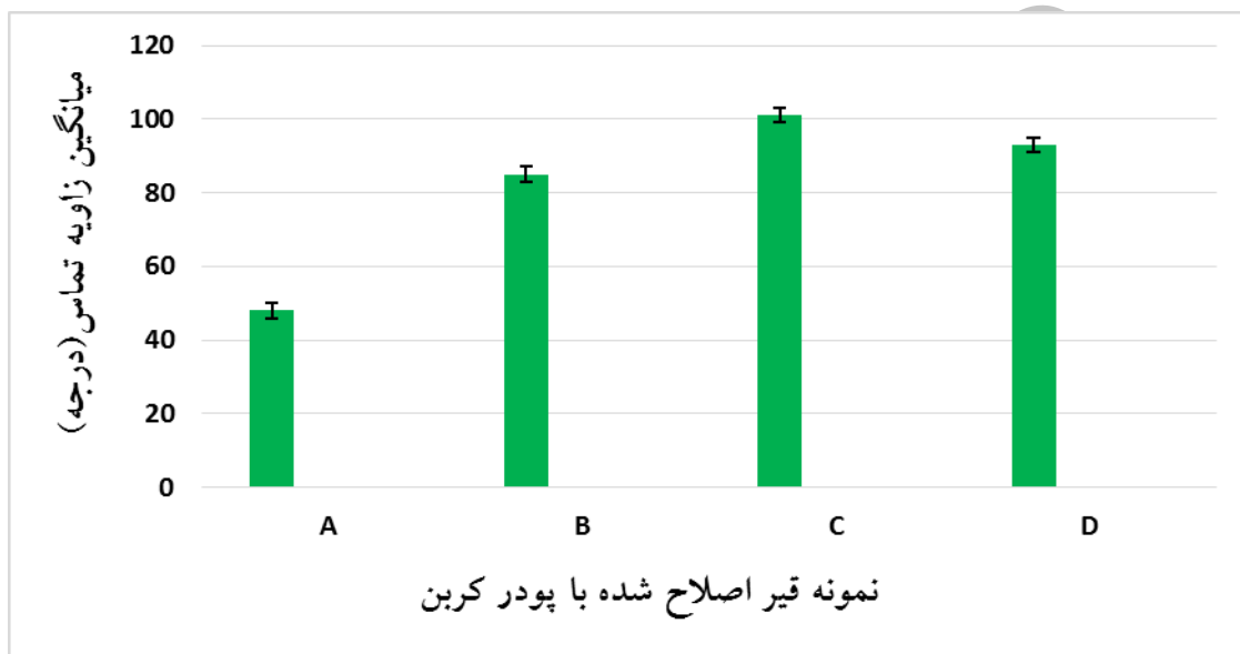
شکل ۶. نتایج آزمایش زاویه تماس برای قیر شاهد و قیرهای اصلاح شده با پودر کربن
