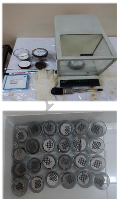
شکل ۸. ترازوی با دقت ۰/۰۰۰۱ گرم و دیگر تجهیزات برآورد مکش خاک به همراه بخشی از نمونه‌های آماده شده
