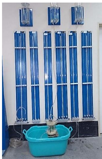
شکل ۷. آزمایش نفوذپذیری منطبق بر روش بار افتان
