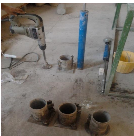
شکل ۱۱. تراکم نمونه‌ها با استفاده از تراکم لرزهای
