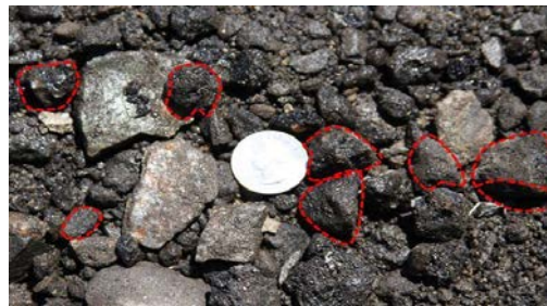
شکل ۸. گوشه‌دار و درشت‌دانه بودن مصالح آسفالتی
