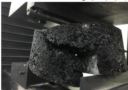
شکل ۷. انجام آزمایش شکست در بارگذاری مود III در نمونه تا لحظه گسیخته شدن
