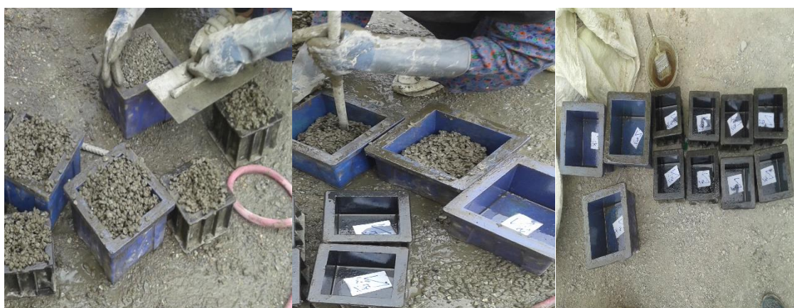
شکل ۴. روند ساخت نمونه‌های بتن متخلخل
