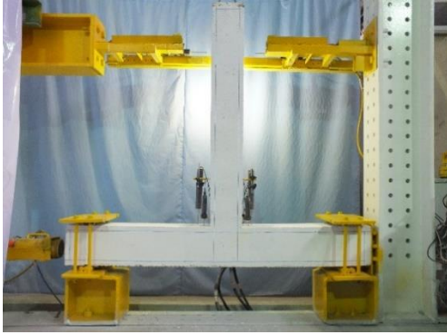
شکل ۵. نمونه اتصال بتنی ضعیف
