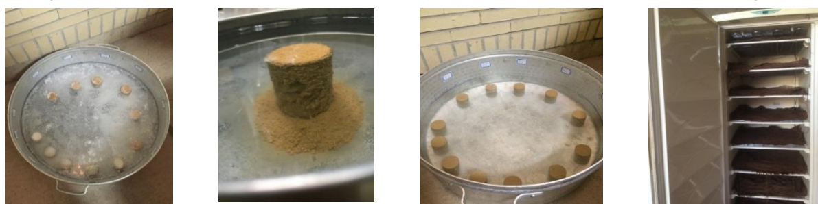
شکل ۱. نحوه‌ی عمل‌آوری نمونه‌ها شکل ۲. نحوه مستغرق کردن نمونه‌ها شکل ۳. نمونه‌ی رسی نمودن شکل ۴. ایجاد لایه‌ی سفید رنگ آهک پس از ۱۴ روز استغراق
