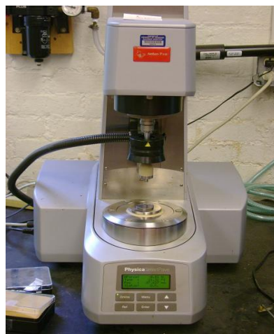
شکل ۲. شماتیک دستگاه رئومتر برش دینامیک
