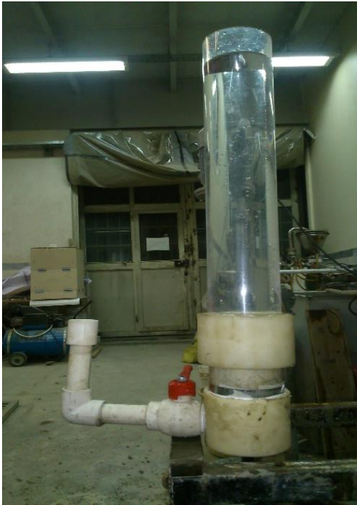
شکل ۳. دستگاه آزمایش نفوذپذیری بتن متخلخل
