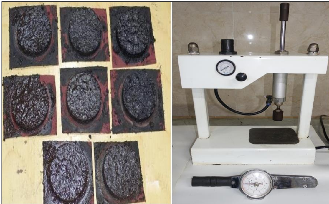
شکل ۴. دستگاه و نمونه‌های آزمایش چسبندگی
