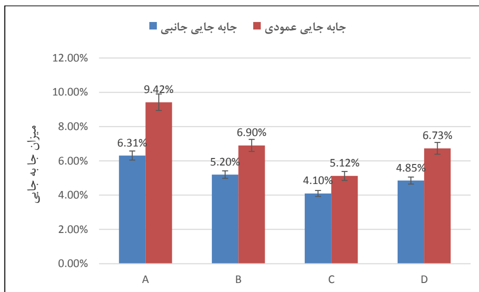
شکل ۹. نتایج آزمایش جابه‌جایی مخلوط‌های میکروسرفیسینگ با چرخ بارگذاری شده
