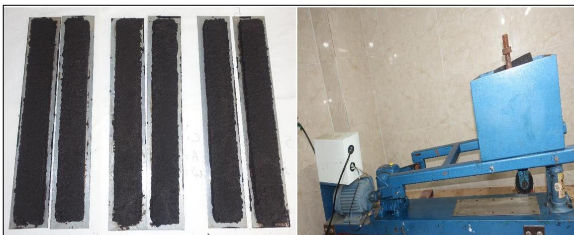
شکل ۶. دستگاه و نمونه‌های آزمایش چرخ بارگذاری
