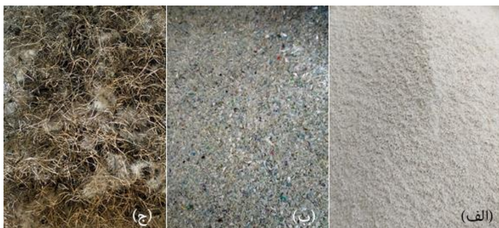
شکل ۲. مصالح مورد استفاده برای ساخت نمونه های مورد آزمایش: الف) متاکائولن، ب) پت و ج) الیاف
