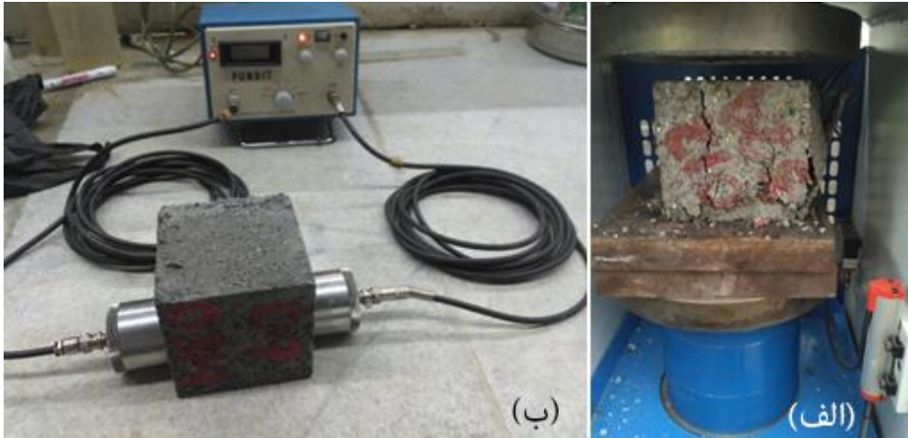
شکل ۴. مراحل انجام آزمایش‌ها بر نمونه‌ها: الف) آزمایش مقاومت فشاری و ب) اندازه‌گیری سرعت امواج التراسونیک
