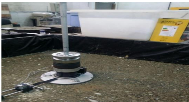
شکل ۱. نحوه انجام آزمایش LWD در این تحقیق
