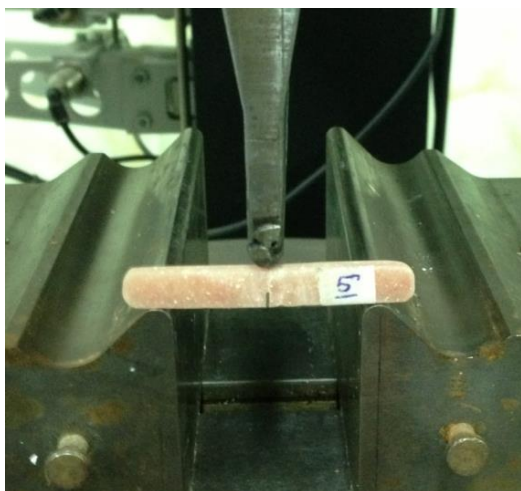
شکل ۴ بارگذاری یکی از قطعات کامپوزیتی ترک دار در داخل دستگاه تست خمش سه نقطه ای
