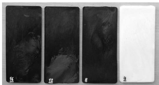
شکل ۲ نمونه‌های فوم شده در درصد‌های وزنی مختلف نانولوله کربنی
