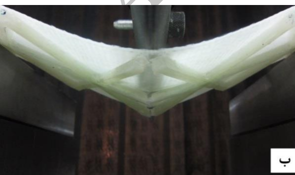
شکل ۱۱ شکست سازه مشبک کامپوزیتی، الف) شکست اولیه سازه تحت بارگذاری عرضی و ب) شکست کامل ریب افقی و جدایش دو ریب مایل از یکدیگر
