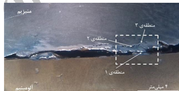
شکل ۳ تصویر ماکروسکوپی از نمونه‌ی ریخته‌گری شده در دمای پیش‌گرم ۴۰۰ درجه‌ی سلسیوس
