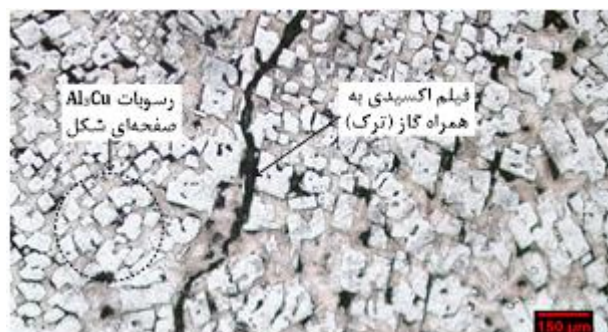
شکل ۱۴ تصویر ثبت شده با میکروسکوپ نوری از ناحیه رسوبات Al_3Cu نمونه‌ی ۵؛ فیلم اکسیدی شناور در توده‌ی مذاب در هر نقطه‌ای ممکن است موجب ترک شود
