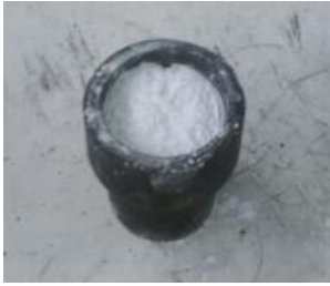
شکل ۷ ریختن پودر در قالب
