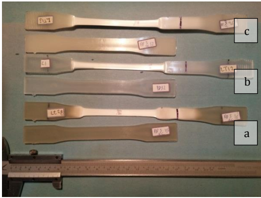
شکل ۶ نمونه‌های آزمون کشش قبل و بعد از آزمون (a) PPNC3 (b) PP (c) PPCC3
