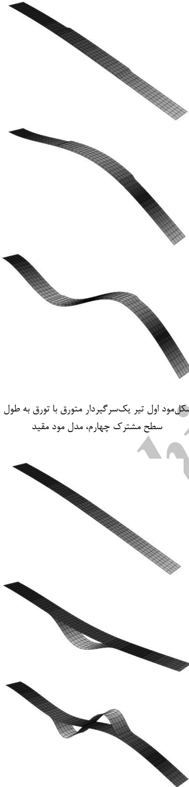
شکل ۶ سه شکل مود اول تیر یک‌سرگیردار متورق با تورق به طول ۰/۴ در وسط سطح مشترک چهارم، مدل مود آزاد
