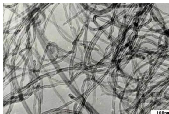
شکل ۱ تصویر میکروسکوپ الکترونی عبوری از نانولوله‌های کربنی چندجداره مورد استفاده در تحقیق حاضر
