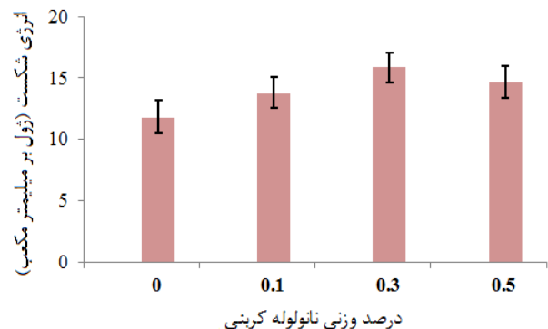
شکل ۷ رفتار جذب انرژی نمونه‌های کامپوزیتی چندمقیاسی بر حسب مقدار نانولوله‌های کربنی افزوده شده تحت آزمون کشش
