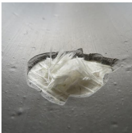
شکل ۱۳ پارگی الیاف و شکست در ماده‌ی زمینه در پوسته‌ی کامپوزیتی
