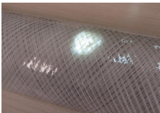
شکل ۱۰ لوله‌ی دارای لاینر روی میز نوری
