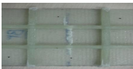
شکل ۱۷ نمونه مربعی ریز پس از انجام تست تجربی
