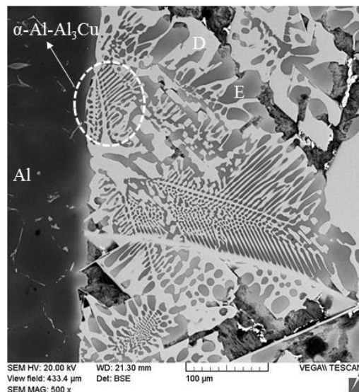
شکل ۱۱ تصویر میکروسکوپ الکترونی روبشی از فصل مشترک سمت آلومینیم (نمونه ۱) که نمایانگر ریزساختار یوتکتیک غیرعادی است.
