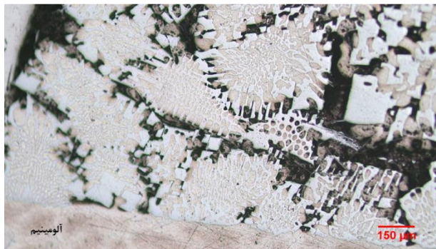
شکل ۹ ریزساختار فصل مشترک سمت آلومینیم دارای ریزساختار یوتکتیک غیرعادی \alpha\text{-Al-Al}_3\text{Cu} ثبت شده با میکروسکوپ نوری (نمونه ۷)
