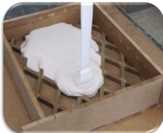
شکل ۲ ریخته‌گری سیلیکون در مدل چوبی
