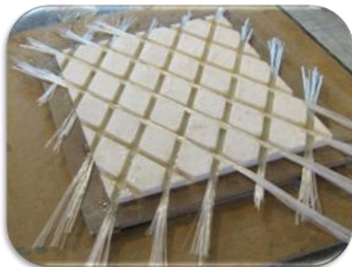
شکل ۴ خواباندن الیاف (بدون پیش تنش اولیه) و آغشته آنها کردن به رزین
