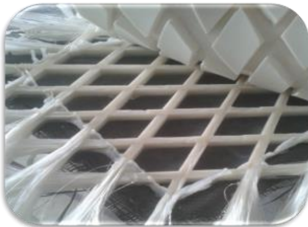
شکل ۱۳ جدا کردن قالب سیلیکونی از هسته و رویه زیرین نمونه شماره ۳
