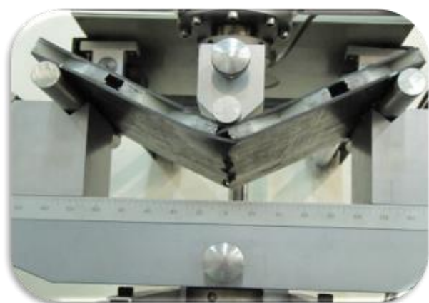
شکل ۲۶ شکست رویه‌های بالا و پایین نمونه و ادامه تحمل بار توسط هسته مشبک شماره ۳
