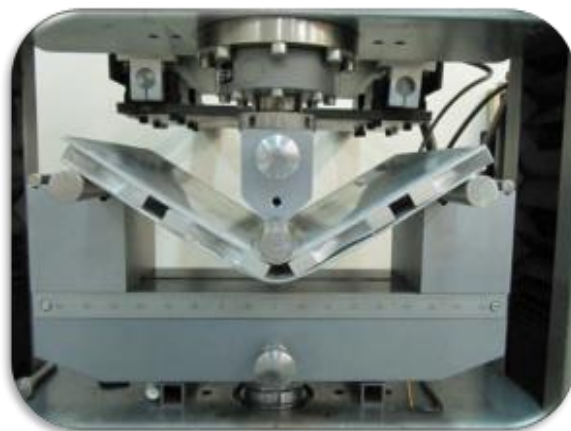
شکل ۲۹ واماندگی نمونه شماره ۴ در لحظه پایان تست
