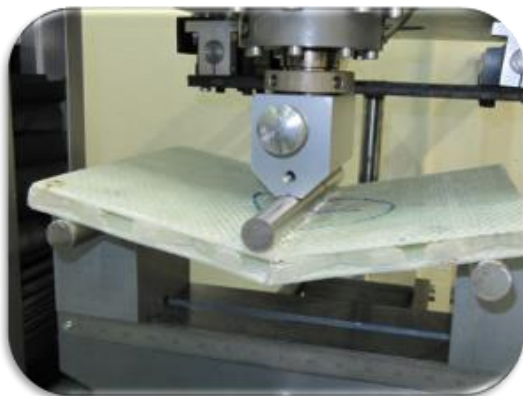
شکل ۲۱ شکست کامل نمونه شماره ۱ در لحظه پایان تست
