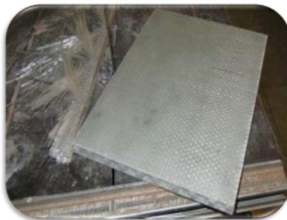
شکل ۹ نمونه شماره ۱ ساخته شده پس از برش زوائد اضافی
