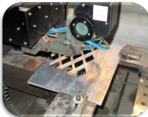
شکل ۱۵ ساخت هسته آلومینیومی با فرآیند برش سیم
