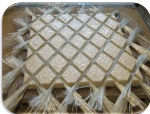
شکل ۵ پرشدن قالب از الیاف و رزین (بدون ایجاد پیش تنش اولیه در الیاف)
