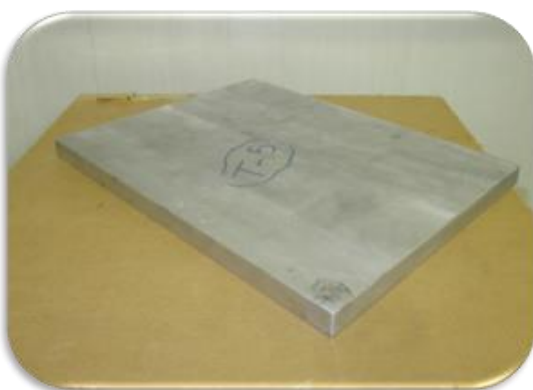
شکل ۱۸ نمونه شماره ۵ (صفحه یکپارچه آلومینیومی)
