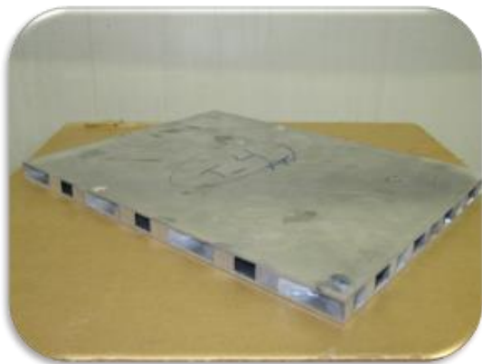
شکل ۱۷ نمونه شماره ۴ سازه ساندویچی با هسته مشبک آلومینیومی و رویه های آلومینیومی
