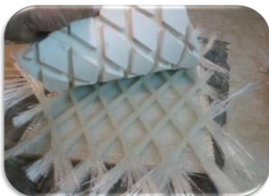
شکل ۷ جدا کردن لاستیک سیلیکون از قطعه (هسته و رویه پایین)
