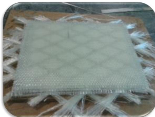
شکل ۸ اتصال پارچه آغشته به رزین رویه بالایی بر روی هسته (در حالت ژله‌ای)
