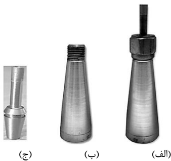
شکل ۳ (الف) ابزار الماسه هسته‌دار، (ب) نگهدارنده ابزار، (ج) مجموعه ابزار ارتعاشی
