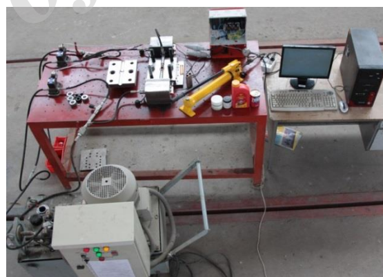
شکل ۳ مجموعه قالب و تجهیزات فرآیند هیدروفرمینگ
