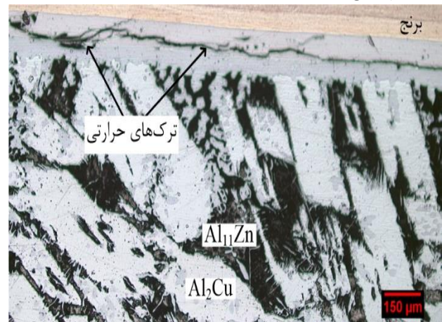
شکل ۱۱ فصل مشترک مجاور برنج نمونه‌ی ۱۶ نشان‌دهنده‌ی تشکیل ترک‌های حرارتی در لایه‌ی اول فصل مشترک ثبت شده با میکروسکوپ نوری
