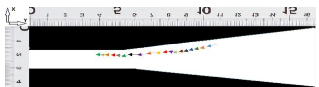
Fig. 19 2D Position of Particle in X & Y Direction of Melt Flow شکل 19 موقعیت دو بعدی ذره در دو راستای افقی و عمودی در جریان مذاب
