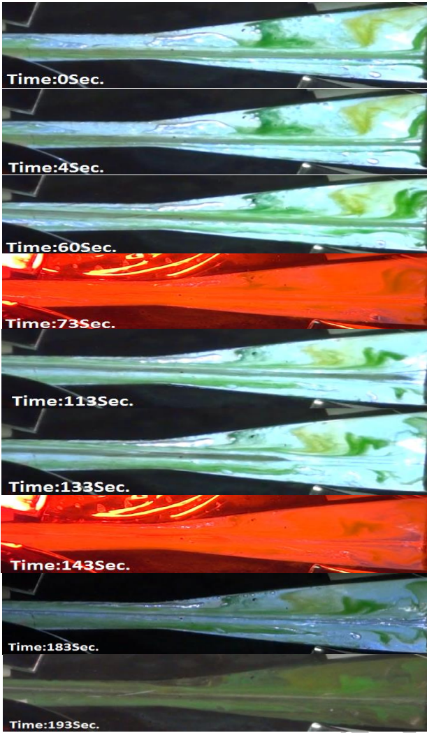
Fig. 16 Progress of Melt Flow in 3 Zone of Mold (in different colors) شکل 16 پیشروی جریان در سه ناحیه قالب (به رنگ سبز، زرد و سبز روشن)
