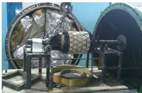
Fig. 4 View of the mandrel on the rotating system and ready to cure شکل 4 نمایی از نحوه‌ی قرارگیری مندرل روی چهارپایه‌ها و آماده شدن برای پخت
