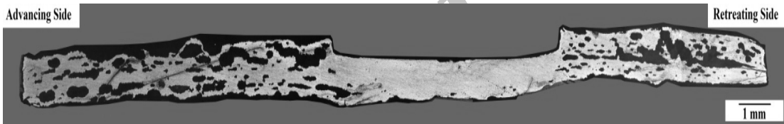
شکل ۴. درشت ساختار حاصل از جوشکاری همزن اصطکاکی فوم تولید شده به روش ARB (۲۵ mm/min - ۹۰۰ rpm)
