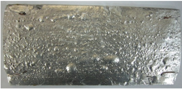
شکل ۲. فوم آلومینیمی تولید شده به روش ARB
