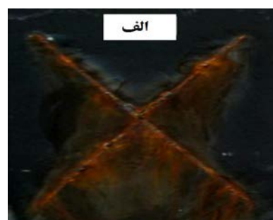
شکل ۹. تصویر پوشش‌های خراش‌دار بعد از ۳۰ روز غوطه‌وری در محلول ۵ درصد کلرید سدیم. الف) نمونه‌ی کنترل، ب) نمونه‌ی شامل ۰/۰۵ درصد وزنی میکروکپسول، ج) نمونه‌ی شامل ۰/۰۱ درصد وزنی میکروکپسول.
