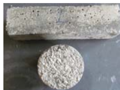
شکل ۷. نمونه‌های مورد آزمایش استحکام فشاری (استوانه‌ای) و خمشی (مکعب مستطیل)
