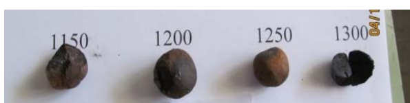
شکل ۸. تصاویر گندله تهیه شده از نمونه حاوی کربن بعد از دماهای مختلف.
