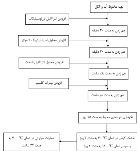
شکل ۱. دیاگرام تهیه شیشه های زیست فعال به روش سل ژل تک مرحله ای.
